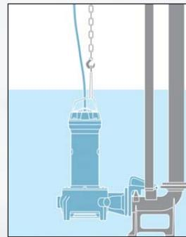
Installation mit BODENBEFESTIGTEM
